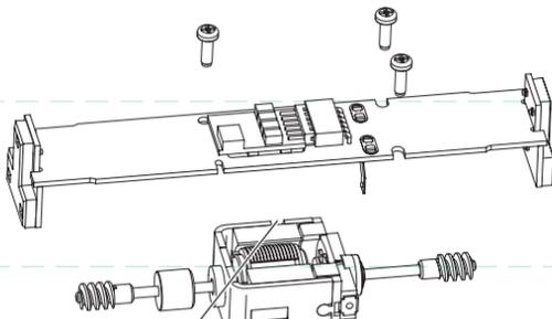
Motorkerbe und Bohrung nach vorne
